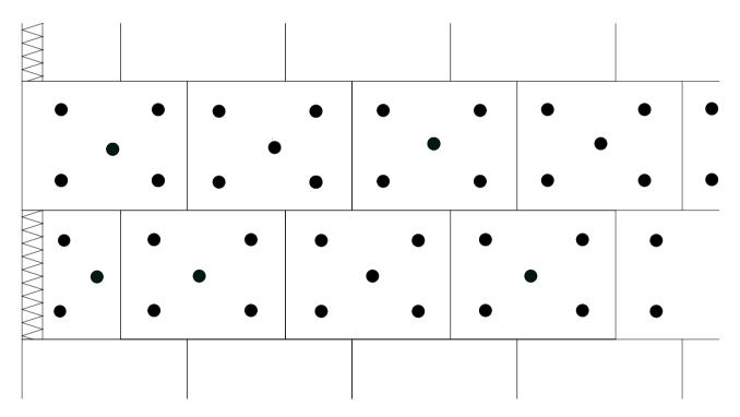
Mindestabstand Dübel zum Plattenrand beträgt 150 mm und zu den anderen Dübelschäften 200 mm
